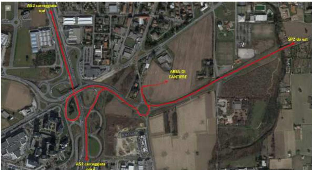
Figura 28 : Percorsi di accesso all'area di cantiere
