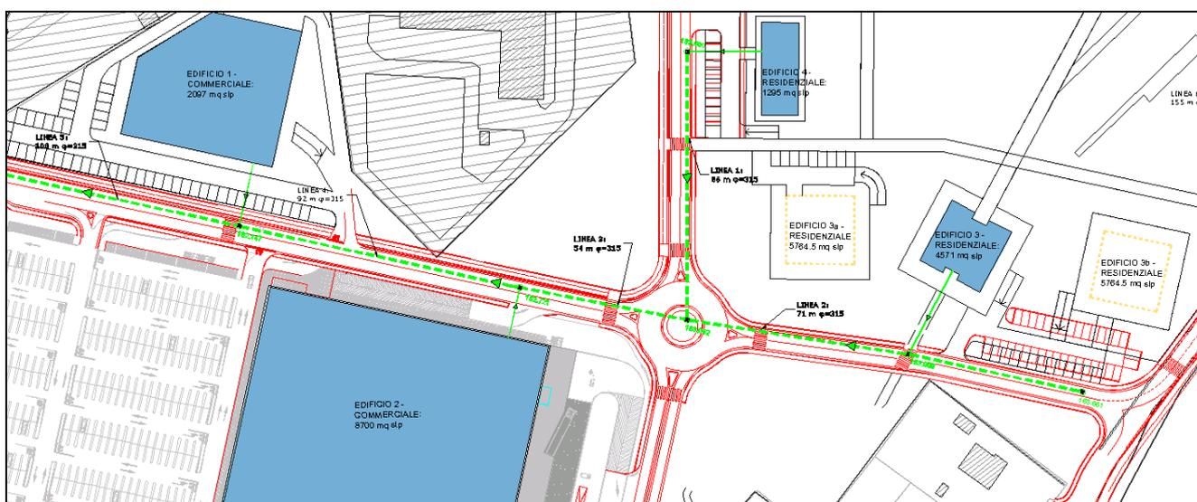
Nell'area Nord dell'intervento, invece, si prevede la deviazione di un tratto di linea esistente per permettere la realizzazione di un edificio a destinazione mista (residenziale e terziario); tale tratta conserverà le dimensioni ( $\Phi 600$ ) e il materiale della condotta esistente. In quest'area si prevedono anche gli allacci dei nuovi edifici residenziali in progetto e quello dell'edificio a destinazione mista.
