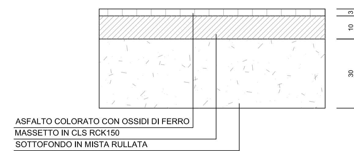
PARTICOLARE PAVIMENTAZIONE PISTA CICLABILE Scala 1:10
