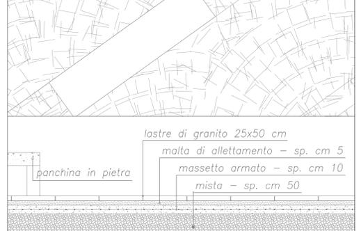
**DETTAGLIO 3: pav. in porfido posa ad archi contrastanti**
