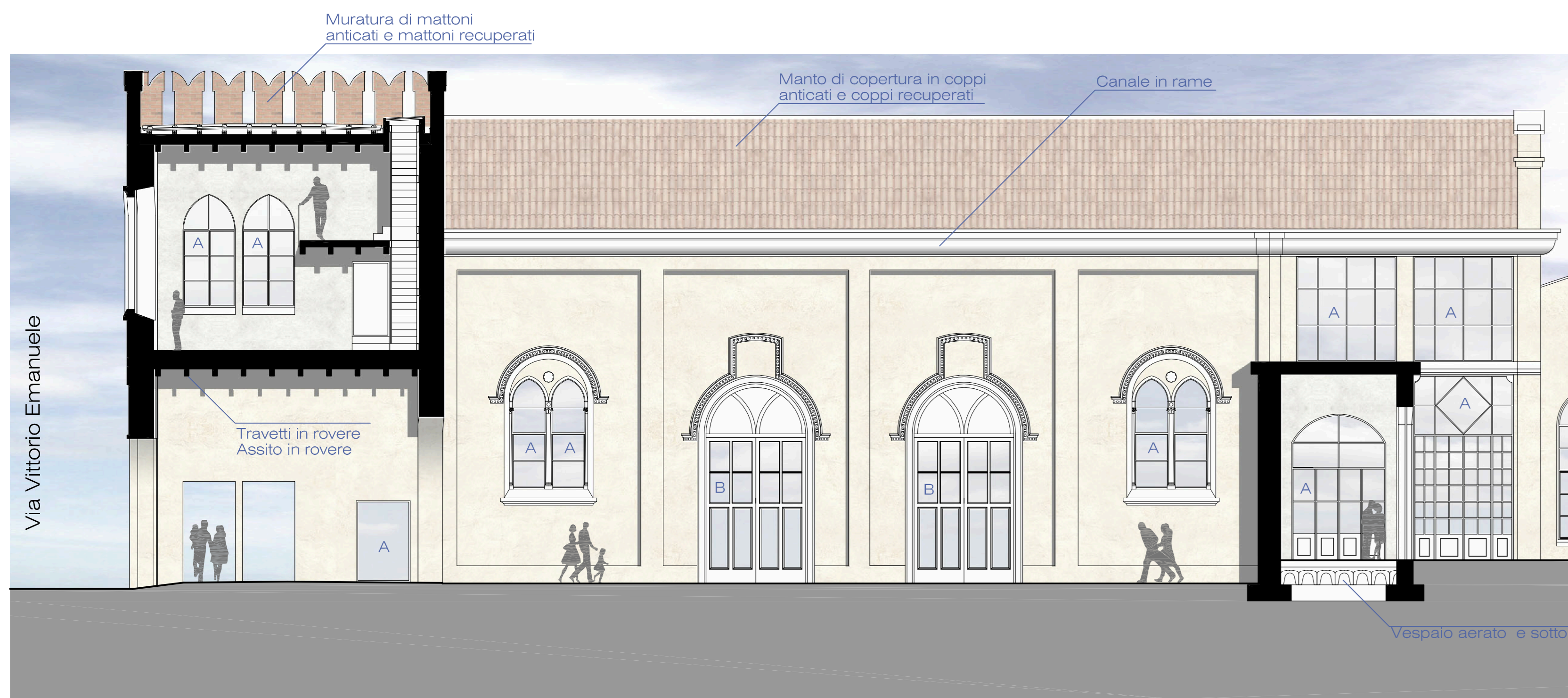
Sezione C/C' - SEZIONE PERCORSO PEDONALE PUBBLICO
